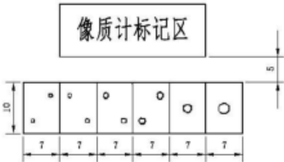
图 D.1 阶梯孔型像质计
